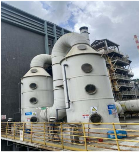
蒸发浓缩预处理及料坑废气处理（碱液喷淋+酸液喷淋+UV光解+活性炭吸附）
