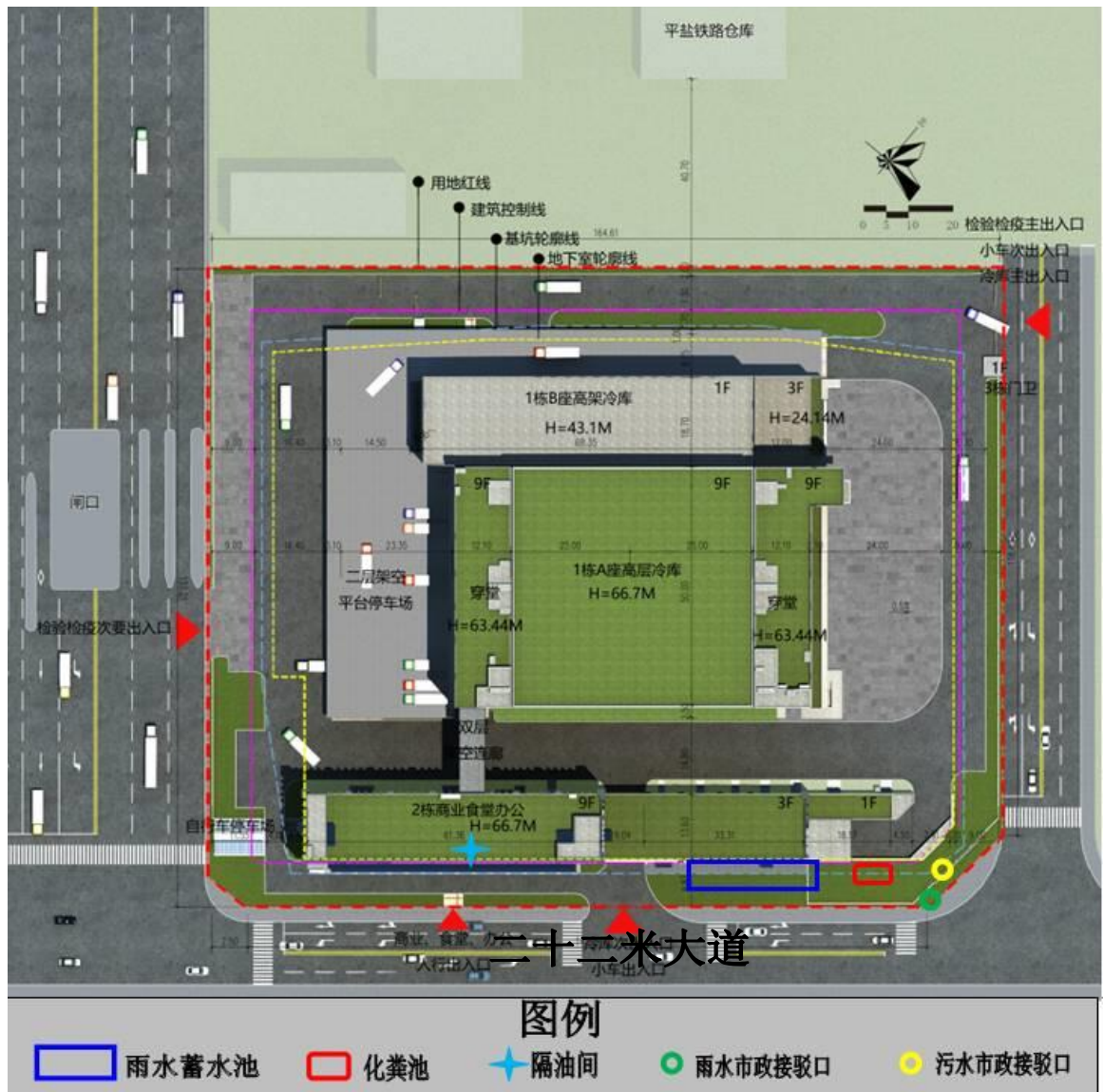
图 4.1-2 雨水蓄水池、雨水和污水市政接驳口、隔油间及化粪池平面布置图
