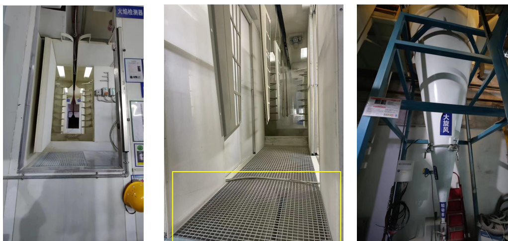
图 4-1 喷粉工序现场废气收集情况图(底部负压收集) 喷粉产生的颗粒物
